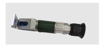
L'indice di rifrazione di un liquido contenente zucchero o altri solidi è proporzionale alla sua concentrazione. I refrattometri manuali sono basati su questo principio e costruiti per essere usati in modo rapido e semplice per la misura della percentuale di zucchero presente nei liquidi.
