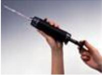
**Due** Allineare la linea rossa selezionante il volume (100 o 50 ml) e tirare fino a quando la corsa non si blocca. Attendere il tempo di campionamento verificando la comparsa dell'indicatore di fine prelievo bianco, posizionato sul fondo del pistone di aspirazione.
