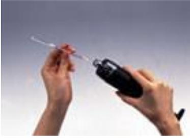
**Uno** Rompere la fiala alle due estremità utilizzando il nuovo sistema con lama di diamante inserito nella pompa. Verificare che la pompa sia azzerata. Introdurre la fiala verificando la freccia indicante la direzione del flusso, verso l'ingresso della pompa.
